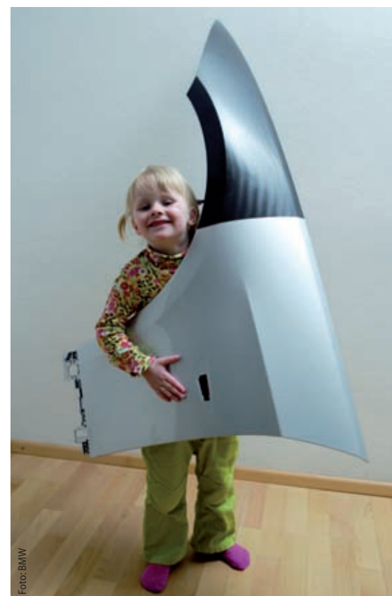
Leichte Kunststoff-Karosserieteile lösen zusehends schwere Bleche ab.
